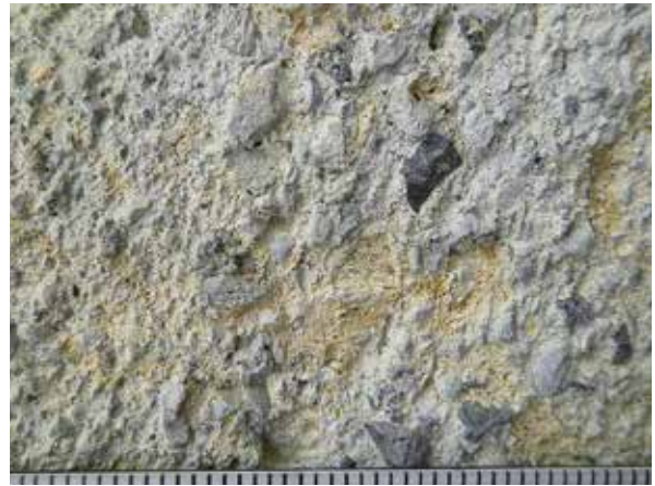
資料2 稜線をもつ加工石片 流紋岩質火山礫凝灰岩 上部ドンズルボー層の凝灰岩 高山石切場跡付近の石
