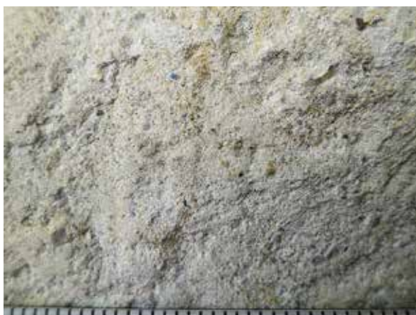
資料4 鑿跡が残る石片 流紋岩質火山礫凝灰岩 上部ドンズルボー層の凝灰岩 高山石切場跡付近の石
