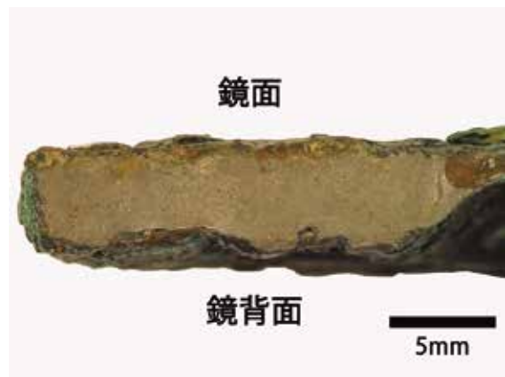
図70 画文帯神獣鏡の破断面(外区)
