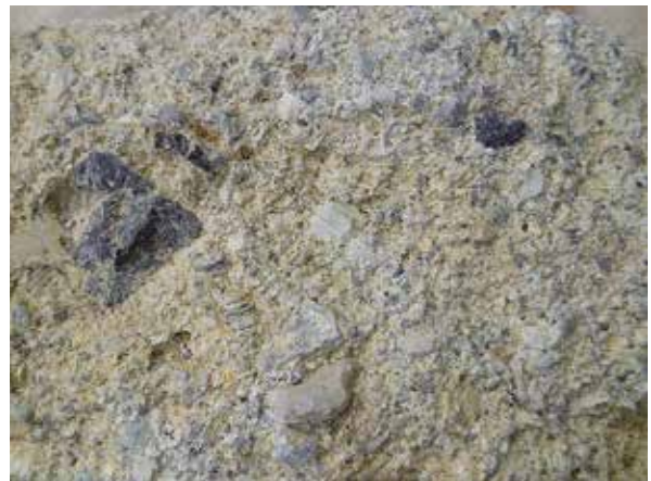
資料4 加工面が残る石片流 流紋岩質火山礫凝灰岩 上部ドンズルボー層の凝灰岩 高山石切場跡付近の石
