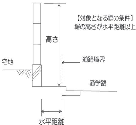
・次の図に示すとおり、ブロック塀などの高さが道路境界までの水平距離より高いもの
