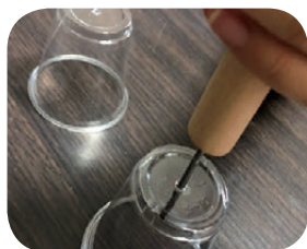
①キリなどでプラカップの底の真ん中に穴をあける
